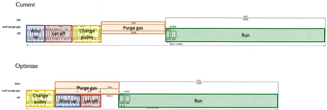
รูปที่ 4.2 Simograms เปรียบเทียบการทำงานของคนเปลี่ยน pulley ต่อ เครื่องจักร 1 เครื่อง ก่อนและหลังปรับปรุง
