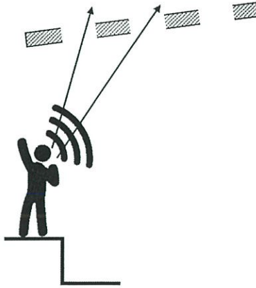
ภาพที่ 2.27 แผงสะท้อนติดวัสดุดูดซับเสียง
