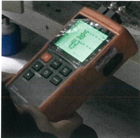
รูปที่ 3.23 หน้าจอมอเตอร์แสดงผลค่าการสั่นสะเทือนของมอเตอร์
