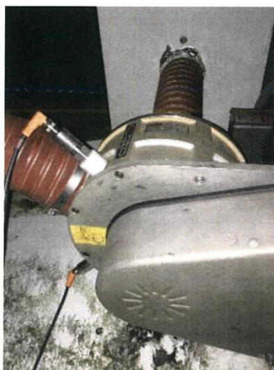
รูปที่ 3.28 ตำแหน่งการติดตั้ง Vibration Transmitters ในลักษณะตั้งฉากกัน
