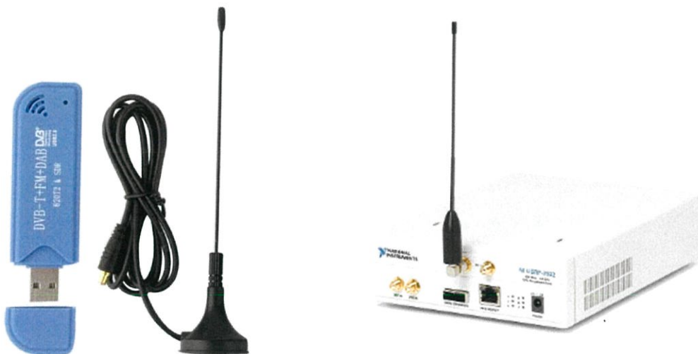
รูปที่ 2.1 ตัวอย่างฮาร์ดแวร์ที่ใช้ระบบ SDR (SDR Dongle และ USRP)
