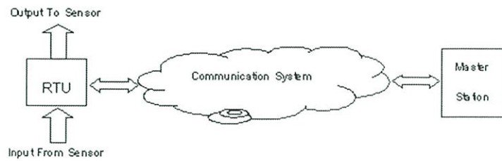
รูปที่ 2.35 แสดงส่วนประกอบหลักของระบบ SCADA
