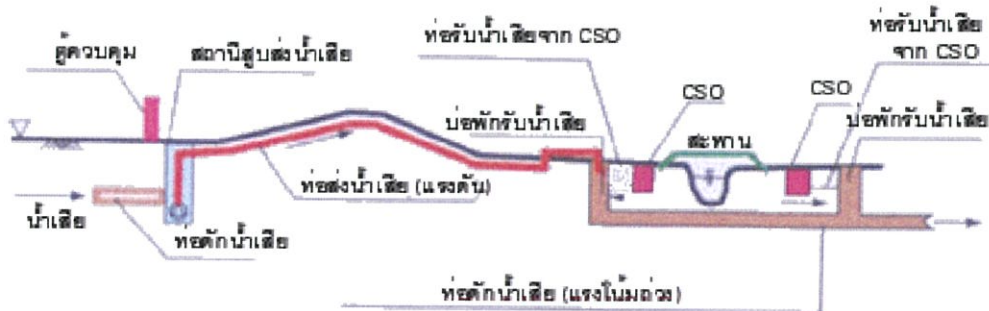
รูปที่ 2.3 การส่งสูบน้ำเสียโดยแรงดัน
