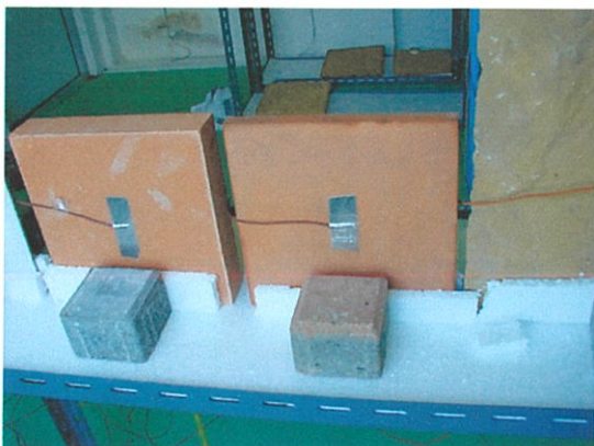
ภาพที่ 6.1 แสดงลักษณะของการวางของวัสดุและจุดวัดอุณหภูมิที่ทำการทดลอง
