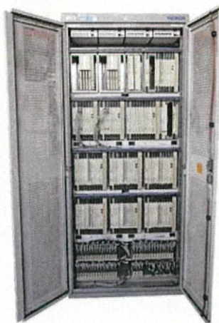
รูปที่ 2.30 Base Station Controller (BSC)
