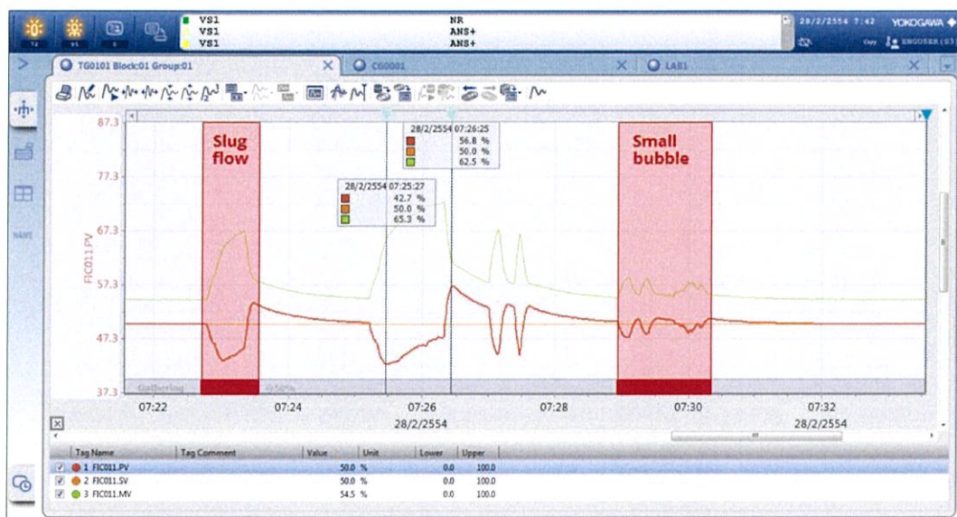
ภาพที่ 4.20 ความผิดปกติของกราฟในโปรแกรมDCS
