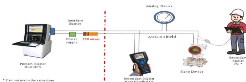
ภาพที่ 2.26 แสดงการต่อ Host ทั้ง Primary Host, Secondary Host และ Device HART
