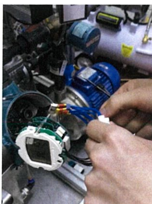
ภาพที่ 3.22 การทดสอบการเตือนของสายเซนเซอร์แต่ละเส้น
