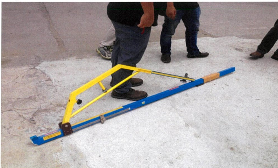
ภาพที่ 22 เครื่องวัดระยะห่างและความสูงของขานชลากับรางรถไฟ
