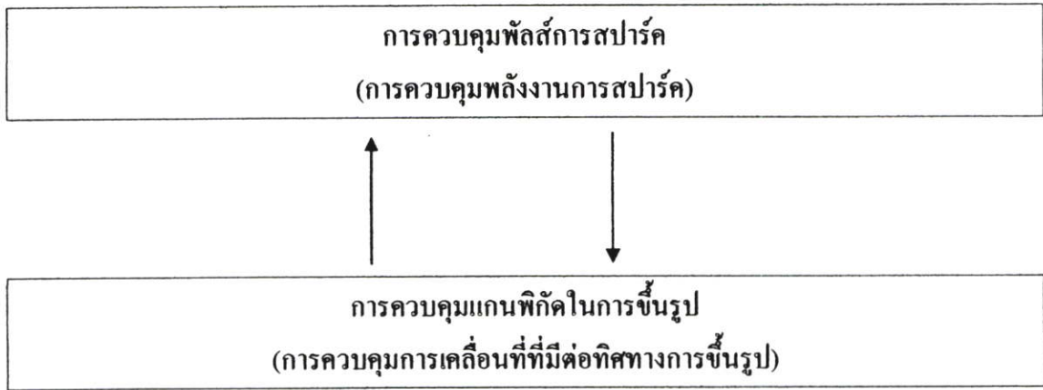
รูปที่ 3.18 องค์ประกอบของการควบคุมเครื่อง EDM
