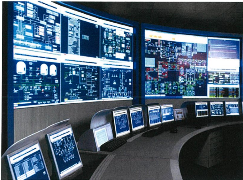
ภาพที่ 2.5 SCADA
