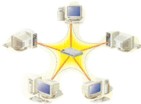
ภาพที่ 2.19 โครงสร้างเครือข่ายคอมพิวเตอร์แบบดาว (Star Network)
