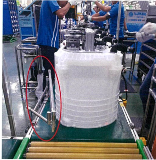
รูปที่ 5.2 หลังทำการติดตั้ง Guide
