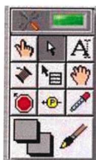
รูปที่ 2.8 Tools Palette ที่ใช้ในการออกแบบ Front Panel
