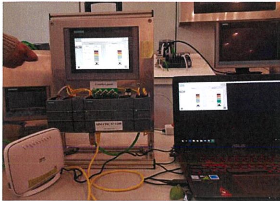
รูปที่ 4.8 การใช้งานฟังก์ชัน Smart Server / Smart Client ผ่านคอมพิวเตอร์
