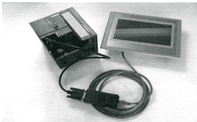
รูปที่ 2.21 แสดงการเชื่อมต่อระหว่าง PC กับ PLC ผ่านสายเคเบิลเอ็มพีไอ (MPI Cable)
