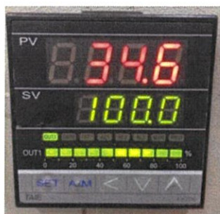
ภาพที่ 3.17 แสดงหน้าจอของเครื่องควบคุมฟังก์ชันพีไอดี ไม่ได้อยู่ในโหมด Manual
