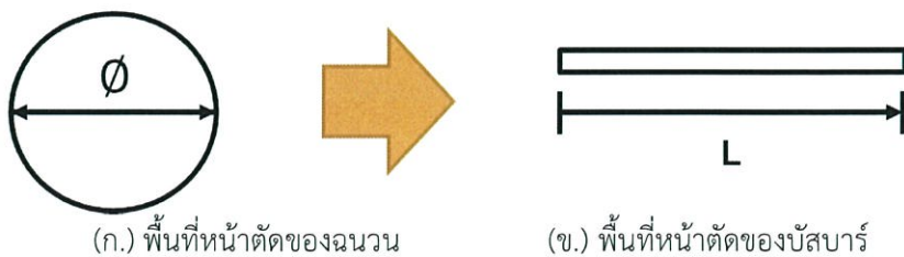
ภาพที่ 3.21 แสดงภาพตัวอย่างการแปลงพื้นที่หน้าตัดของฉนวนทรงกลม มาเป็นตามลักษณะของบัสบาร์
