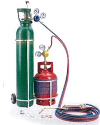
ภาพที่ 3.5 ตัวอย่างถังแก๊สและอุปกรณ์เป่าให้ความร้อนกับฉนวน
