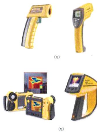
ภาพที่ 2.39 ไพโรมิเตอร์ชนิดอินฟราเรด (ก) เทอร์โมมิเตอร์ชนิดอินฟราเรด (ข) กล้องถ่ายภาพความร้อน (ภาพผลิตภัณท์ FLUKE)
