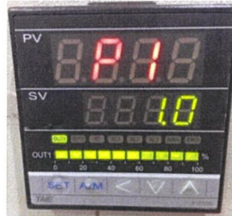
ภาพที่ 3.18 ตัวอย่างหน้าจอแสดงค่าของการควบคุมพี
