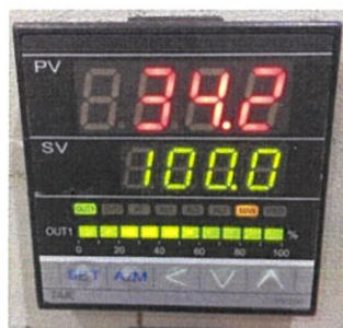
ภาพที่ 3.16 แสดงหน้าจอของเครื่องควบคุมฟังก์ชันพีไอดี อยู่โหมด Manual
