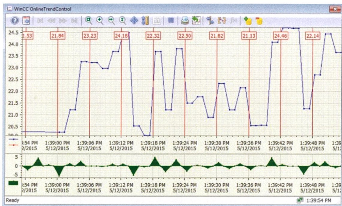
ภาพที่ 2.30 ตัวอย่าง Trend Control บน SIMATIC WinCC Online
