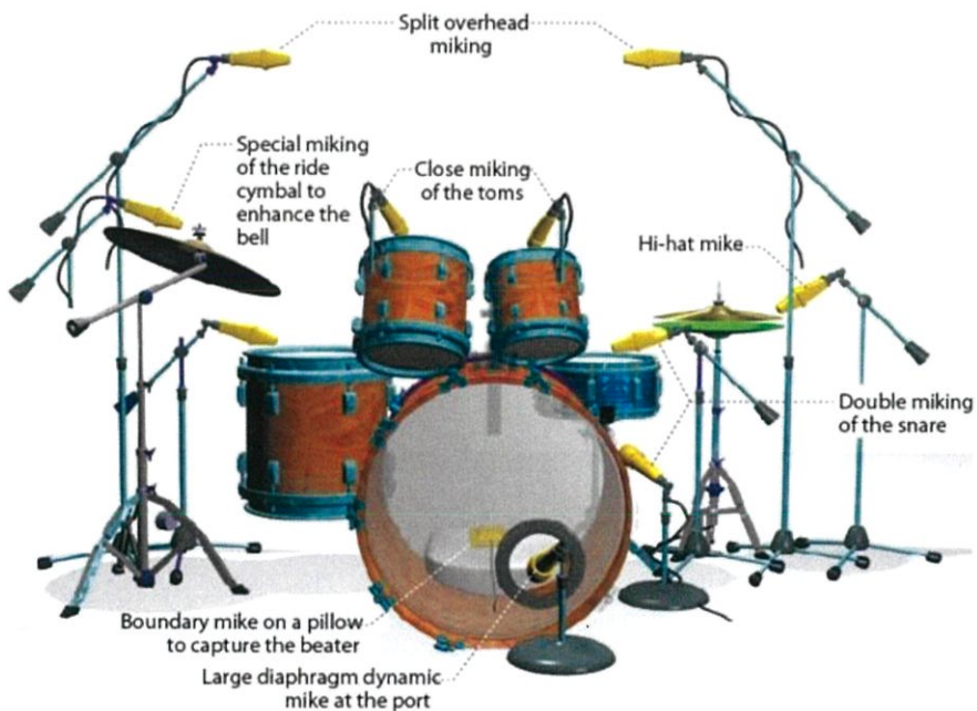
ภาพที่ 3.4 วิธีการตั้งไมโครโฟนเพื่อบันทึกเสียงของกลอง
