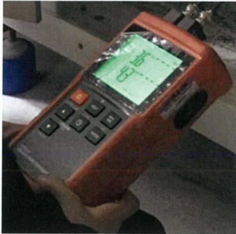
รูปที่ 3.23 หน้าจอมิเตอร์แสดงผลค่าการสั่นสะเทือนของมอเตอร์
