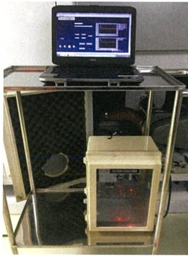
รูปที่ 3.26 ระบบวัดค่าการสั่นสะเทือนของมอเตอร์โดยแสดงผลผ่านโปรแกรมแลปวิว
