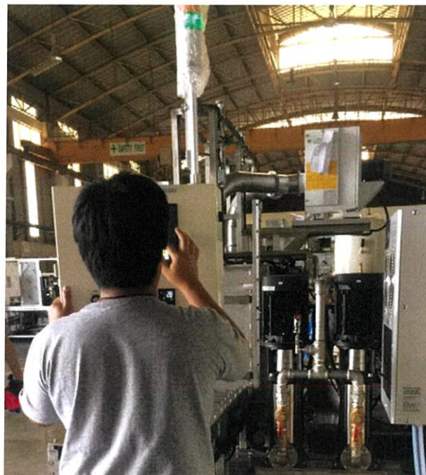
รูปที่ 4.16 ทดสอบการทำงานของเครื่องจักรผ่านหน้าจอ Touch Screen
