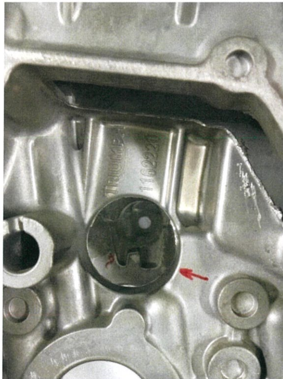
รูปที่ 4.7 รูปแสดงรูเจาะขนาด Dia30 บนเสื้อสูบ
