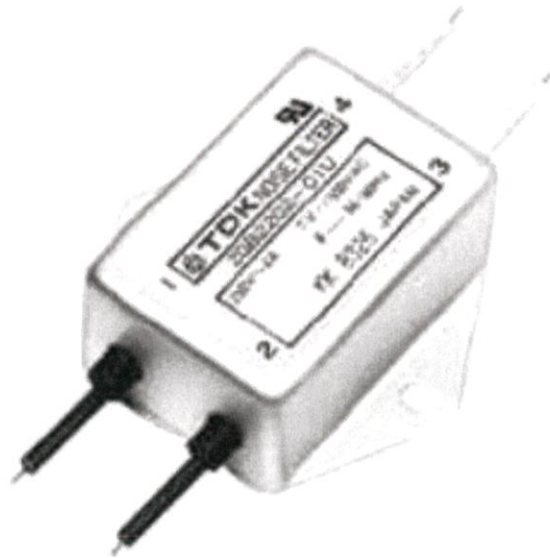
รูปที่ 2.24 Noise Filter รุ่น ZGB2203-01U ของ TDK-LAMBDA
