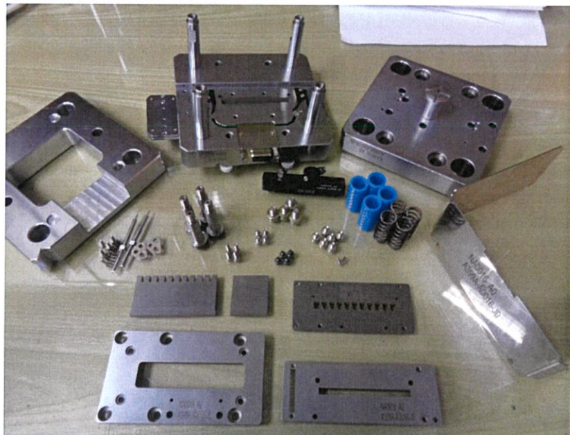
รูปที่ 3.34 แสดงส่วนประกอบทั้งหมดของเครื่องมือ Cutting Tool
