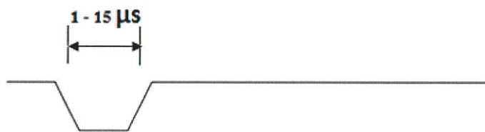
รูปที่ 2.48 สัญญาณ write สำหรับ ลอจิก 1
