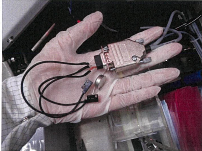
รูปที่ 4.16 แสดงการนำหน่วยความจำเสียบต่อกับสายพอร์ตเข้าเครื่อง Clip Bonder
