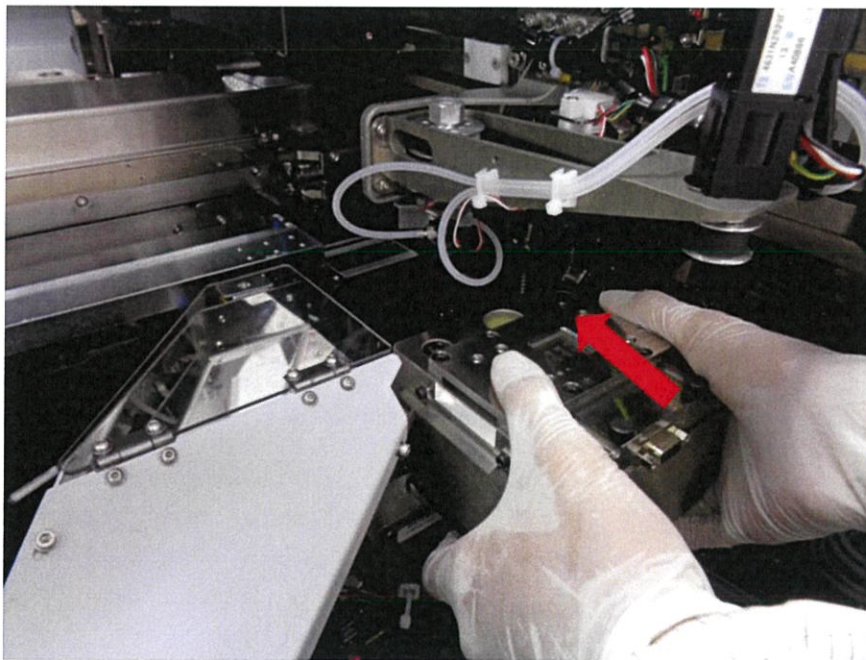
รูปที่ 3.3 แสดงการใส่เครื่องมือตัด (Cutting Tool) ลงไปในเครื่องจักร Clip Bonder
