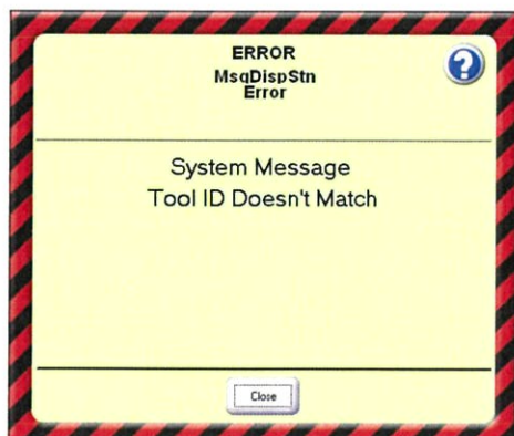
รูปที่ 4.14 แสดงว่าเมื่อนำเครื่องมือตัดตัวอื่นมาใส่ที่ไม่ตรงกับเครื่องจักร Clip Bonder
