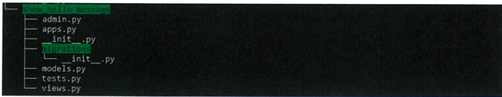
ภาพที่ 17 แสดงโครงสร้างภายในแอปพลิเคชัน show_hello_message
