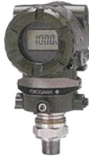
รูปที่ 2.21 Pressure Transmitter ชนิดไดอะเฟรม
