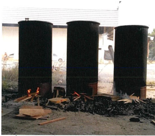
รูปที่ 3.9 หม้อนึ่งก้อนเพาะเห็ดขนาด 200 ลิตร
