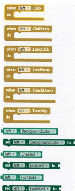
รูปที่ 2.34 ตัวอย่างของบล็อกคำสั่งประเภทที่ใช้เรียกค่าคุณสมบัติจากคอมโพเนนต์ (Property Getter)
