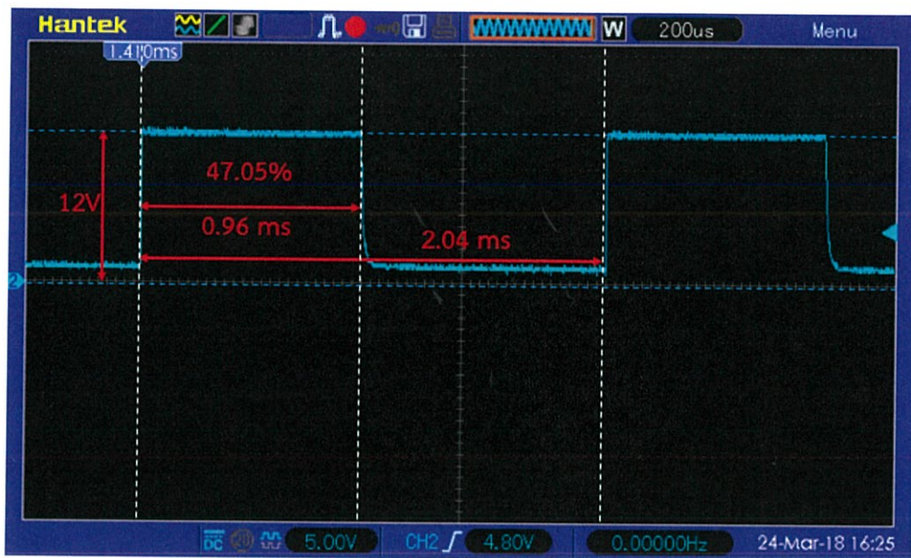
รูปที่ 4.17 สัญญาณเอาต์พุต PWM ของวงจร H-Bridge 2 ในสถานะ RIGHT
