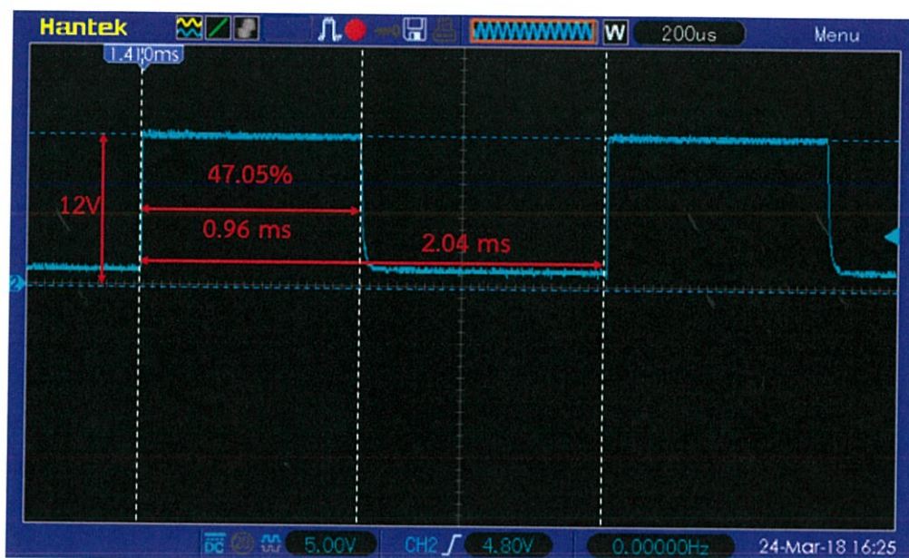
รูปที่ 4.11 สัญญาณเอาต์พุต PWM ของวงจร H-Bridge 2 ในสถานะ BACKWARD
