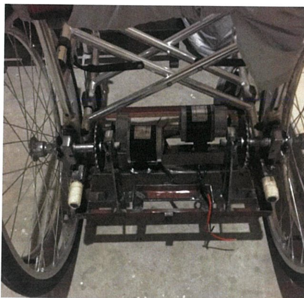
รูปที่ 3.4 โครงสร้างช่วงล่างที่ติดตั้งเพื่อรองรับอุปกรณ์และกลไกในการขับเคลื่อน
