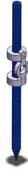
รูปที่ 3.9 แบบจำลองของส่วนที่ยึดจับของหุ่นยนต์แขนกล 6 แกน ขณะจับปากกา
