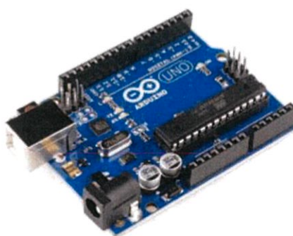
รูปที่ 2.13 ไมโครคอนโทรลเลอร์ Arduino Uno R3
