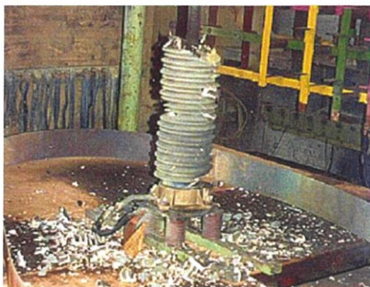
ภาพที่ 2.18 ความเสียหายของลูกถ้วยแบบผิวกระเบื้อง (ซ้าย) และแบบพอลิเมอร์ (ขวา) [2]
