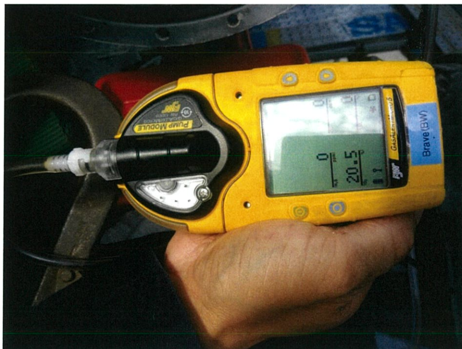
ภาพที่ 4.6 การตรวจสอบปริมาณก๊าซออกซิเจนภายในถึงน้ำมันสำรอง
