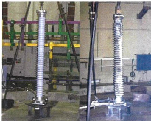
ภาพที่ 2.18 ความเสียหายของลูกถ้วยแบบผิวกระเบื้อง (ซ้าย) และแบบพอลิเมอร์ (ขวา) [2]
