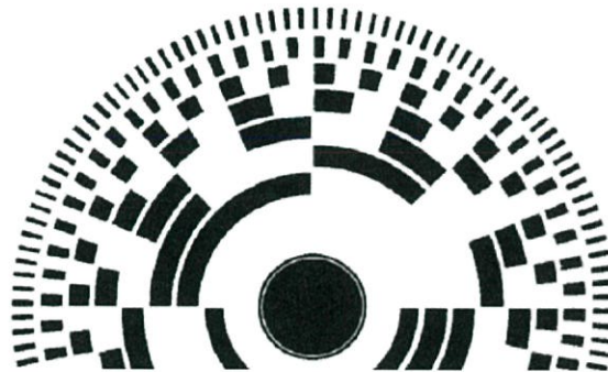
รูปที่ 2.49 ตัวอย่างแผ่น Disc ของ Absolute
