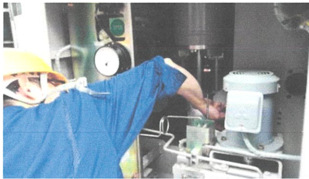
ภาพที่ 4.72 แสดงตัวอย่างการทาจาระบี Low temperature grease (ฝาฟ้า)
