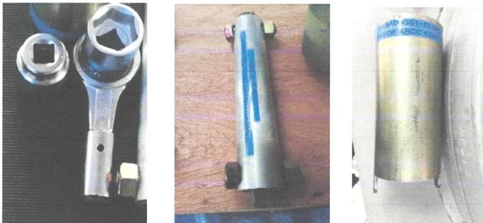
ภาพที่ 4.42 อุปกรณ์ที่ใช้ในการถอด/ประกอบ Moving arc contact
