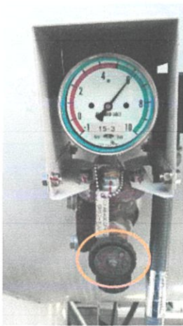
ภาพที่ 4.56 หลังเติมก๊าซเสร็จให้ทำการปิด Service valve(NC) และเปิด Test Valve(NO) เอาไว้
