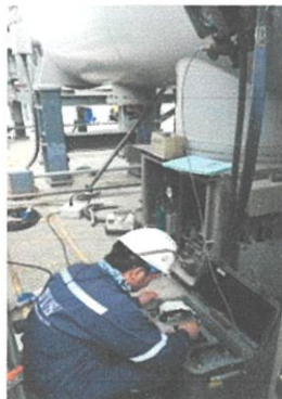
ภาพที่ 4.136 ตัวอย่างการตรวจวัดหาความชื้นและความบริสุทธิ์ และ ผลที่ได้จาก Bay 2
