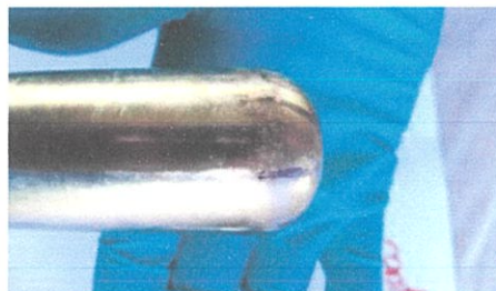
ภาพที่ 4.31 ตัวอย่าง Stationary arc contact ที่นำออกมาตรวจสอบ(อาจมีรอย Arc)
