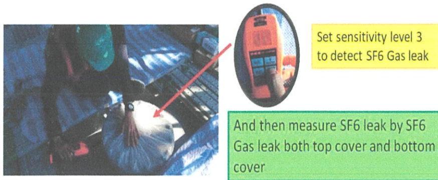
ภาพที่ 4.138 แสดงวิธีการตั้งค่าเครื่องมือตรวจวัดก๊าซซรั่วไหลทั้งฝาดบนและฝาดล่าง (โดยทำการวัดหลังจากเติมเสร็จไปแล้วอย่างน้อย 3 ชม.)
