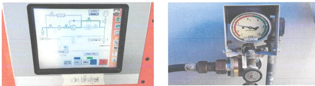
ภาพที่ 4.19 เปลี่ยนโหมดเป็น Recovery เพื่อ Degassing ออกมาสู่ถังเก็บ(ซ้าย) , แสดงถึงค่าความดันที่ค่อยๆลดลง เมื่อผ่านเวลา Degassing ไป (ขวา)
