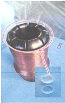
ภาพที่ 4.44 ทาจาระบี Contact grease (ฝาขาว) ที่หน้าสัมผัส (ซ้าย) , แล้วทำการประกอบอุปกรณ์ Moving arc contact กลับ (ขวา)
