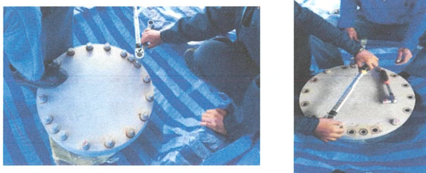
ภาพที่ 4.24 การไข ออกทั้งฝาด้านบนและล่าง ให้ไขตรงข้ามกันตลอดเวลา(ซ้าย), ไขจนเหลือ 2 ตัว จากนั้นใส่อุปกรณ์ช่วยยกฝา (ขวา)
