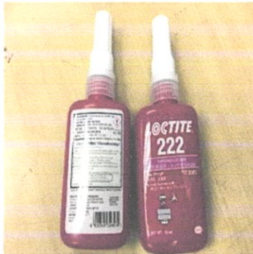
ภาพที่ 4.7 ล็อคเกลียวที่นำมาใช้ในการยึดเกลียวของน็อตแบบต่างๆ
