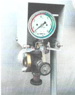
ภาพที่ 4.21 ติดตั้ง filter เพื่อกรองอากาศเข้าไป (ซ้าย), กรองจนค่าความดันภายนอก=ภายใน(0 bar)(ขวา)
