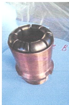
ภาพที่ 4.43 Moving arc contact ที่นำออกมาเพื่อตรวจสอบ
