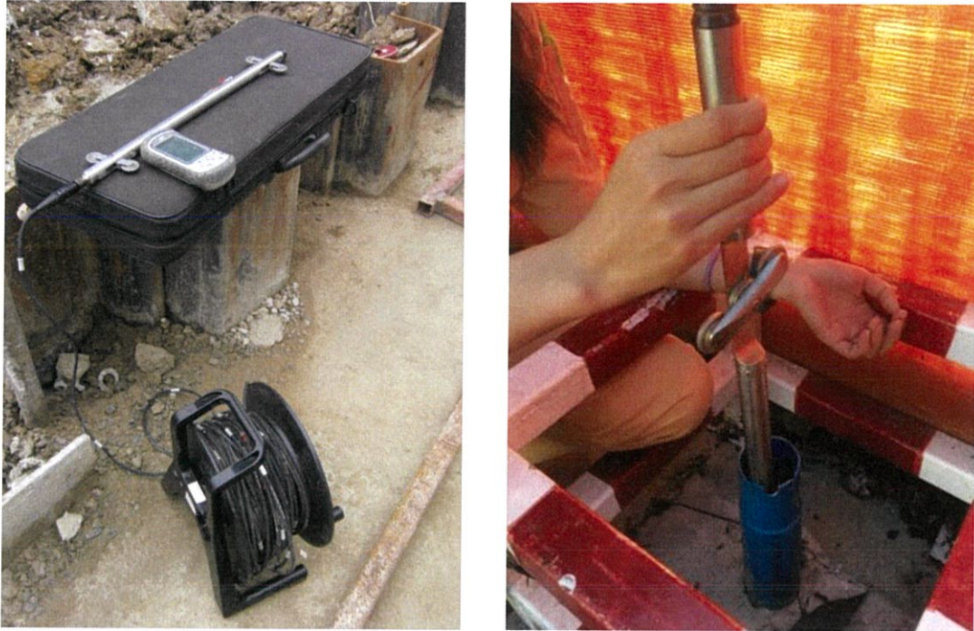
ภาพที่ 3.16 เครื่องมือวัดความลาดเอียง ( Inclinometer Instrument )
