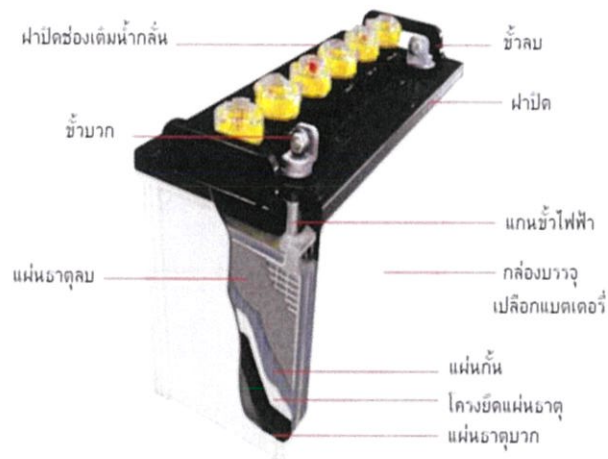
รูปที่ 2.39 ส่วนประกอบของแบตเตอรี่ตะกั่ว-กรด
