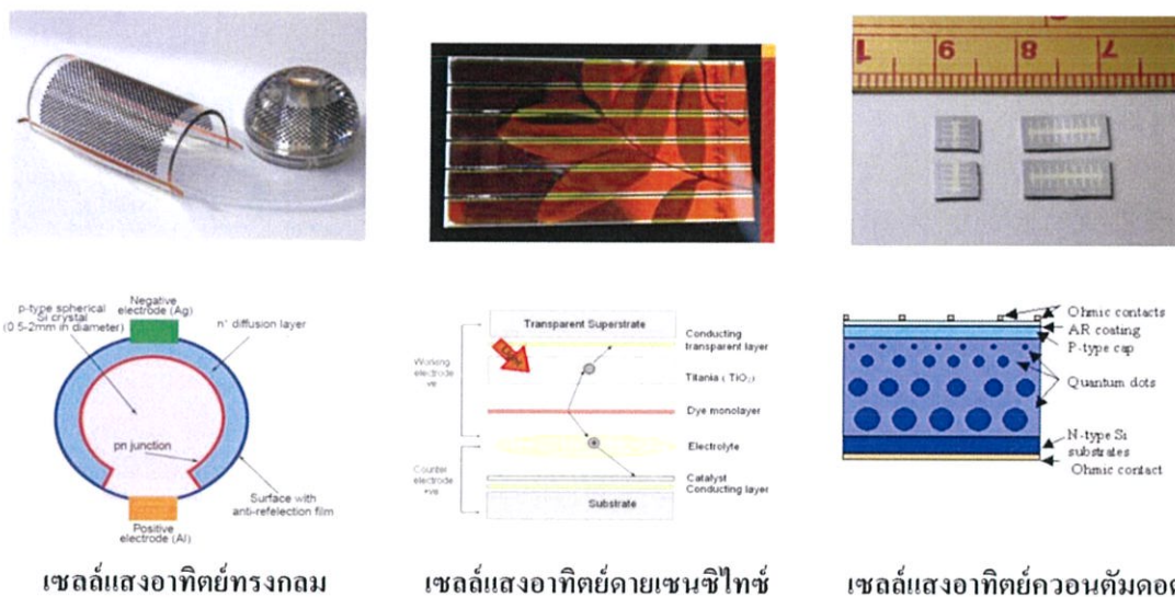
รูปที่ 2.9 ตัวอย่างเซลล์แสงอาทิตย์แบบต่าง ๆ และโครงสร้างภายใน
