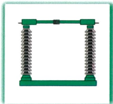
รูปที่ 2.12 Center Side Break Type
