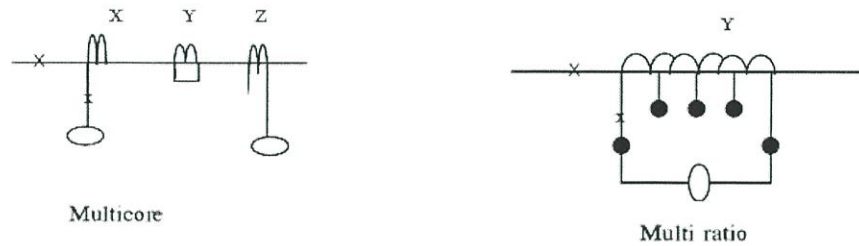
รูปที่ 2.18 แสดงการลัดวงจรของหม้อแปลงกระแส
