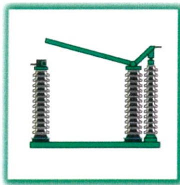
รูปที่ 2.11 Vertical Break Type
