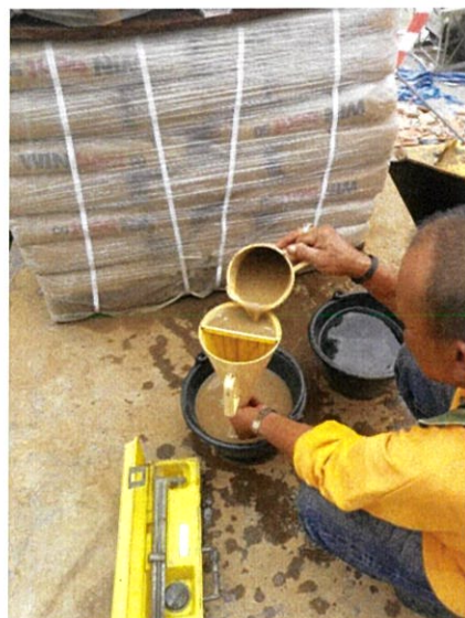
รูปที่ 4.11 การทดสอบหาค่าความหนืดของของเหลวพยุ่ง เสถียรภาพของดิน
