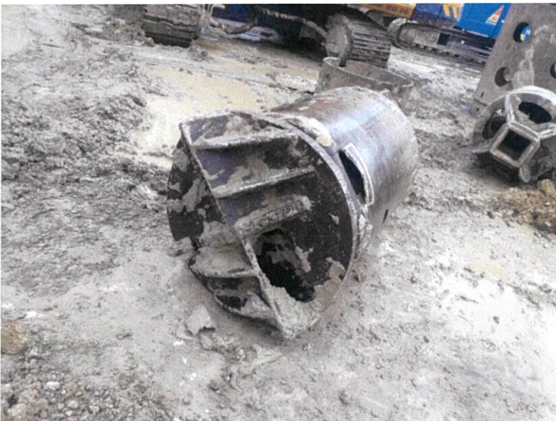
รูปที่ 4.28 หัวทำความสะอาดกันหลุมเจาะ
