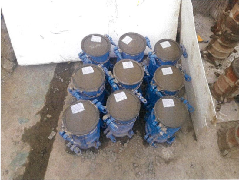
รูปที่ 4.27 ตัวอย่างคอนกรีตที่ถูกเก็บไว้ในแบบ ทรงกระบอก
