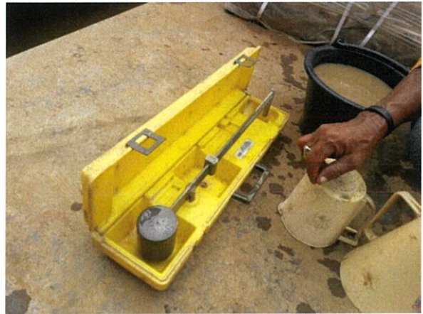
รูปที่ 4.9 การทดสอบหาค่าความหนาแน่นของของเหลว พยุ่งเสถียรภาพดิน
