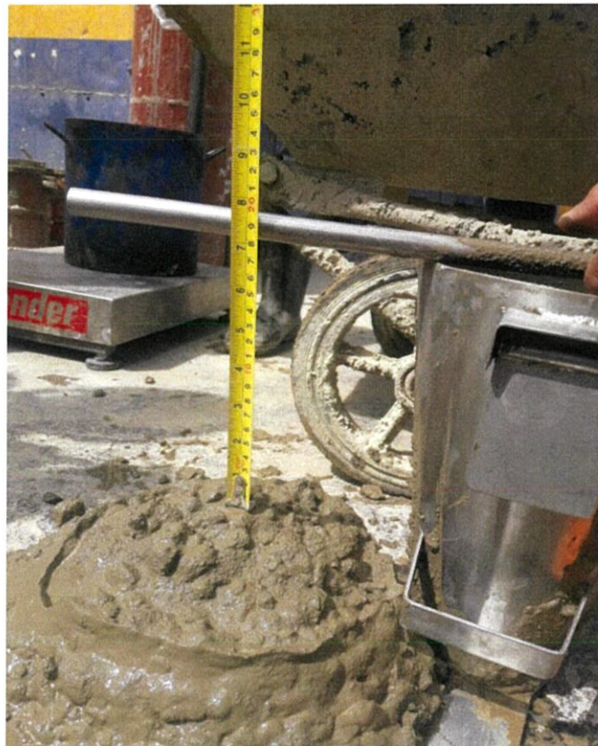
รูปที่ 4.26 การวัดค่าการยุบตัวของคอนกรีตสด
