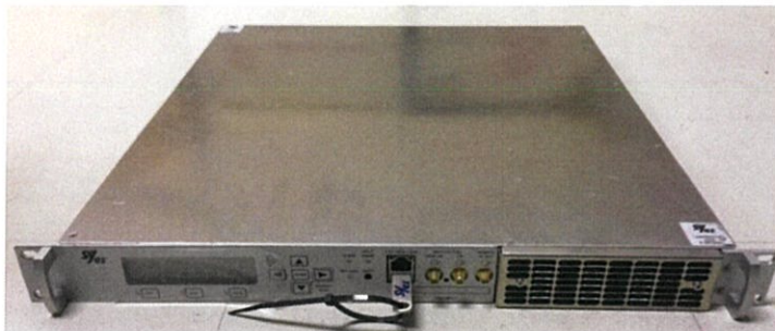
รูปที่ 3.7 เครื่องกำเนิดสัญญาณความถี่วิทยุ
