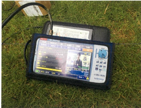
รูปที่ 4.22 ต่อสาย Coaxial cable RG-214 เข้ากับเครื่องวัด BROADCAST ANALYZERS
