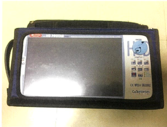
รูปที่ 4.14 เครื่องวัดสัญญาณ BROADCAST ANALYZERS
