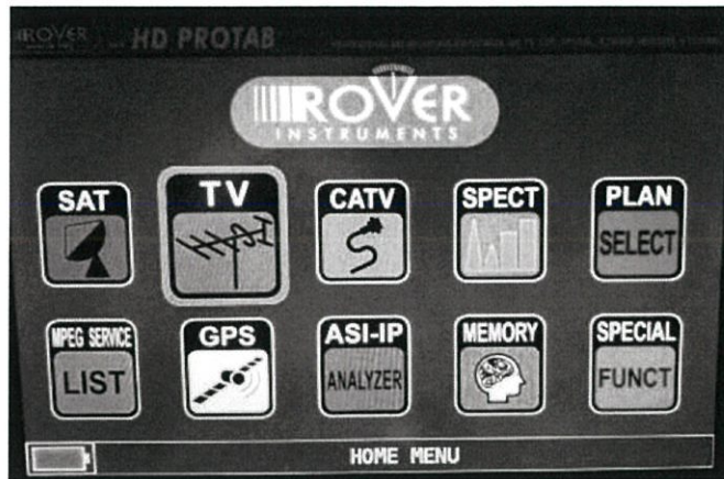
รูปที่ 4.24 เปิดเครื่องวัดสัญญาณ BROADCAST ANALYZERS เลือก TV
