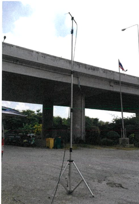
รูปที่ 4.23 ปรับความสูงของเสาตั้งให้มีความสูง 6 เมตร
