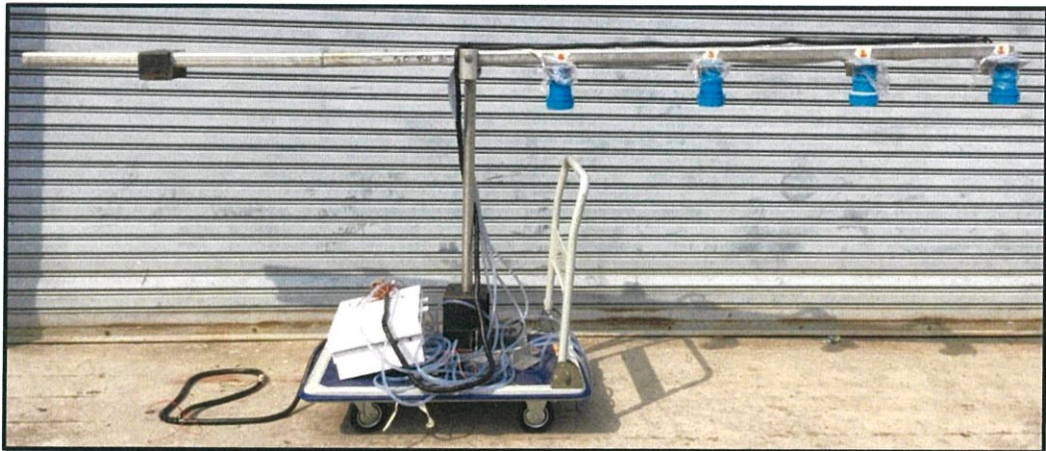
รูปที่ 11 โครงสร้างแขนกลสำหรับติดตั้งอุปกรณ์ที่ใช้ในการกำจัดผักตบชวา
