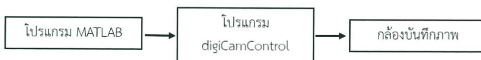
รูปที่ 3.41 แสดงแผนผังการสั่งงานของกล้อง
