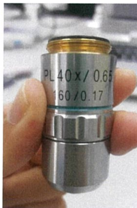
รูปที่ 3.15 เลนส์ใกล้วัตถุที่ใช้ในตัวอุปกรณ์
