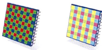
รูปที่ 2.29 แสดงความแตกต่างระหว่างฟิลเตอร์เบเยอร์ (ซ้าย) และฟิลเตอร์แบบ CMYG (ขวา)
