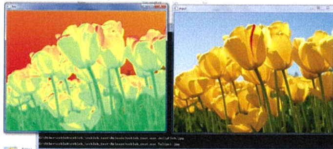
รูปที่ 2.39 ภาพแสดงผลเปรียบเทียบระบบสี HSV กับ RGB
