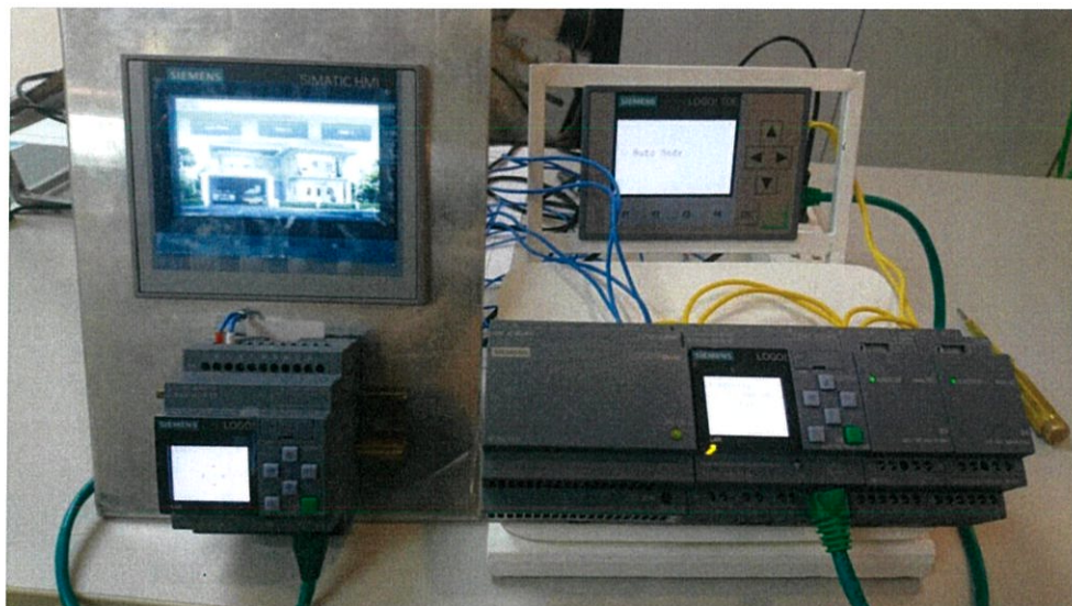
รูปที่ 4.15 การเชื่อมต่อระหว่าง LOGO!8 ทั้ง 2 ตัวและ HMI
