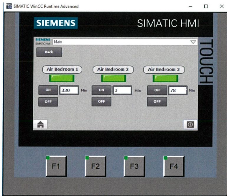
รูปที่ 4.13 หน้าต่างการตั้งค่าเครื่องปรับอากาศของบ้านชั้นที่ 2
