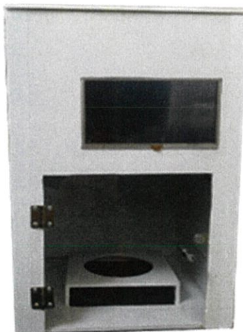
รูปที่ 4.3 ส่วนประกอบของเครื่องตรวจนับโคโลนีอย่างง่าย
