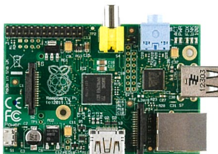
รูปที่ 2.30 อุปกรณ์ที่ใช้ในการติดตั้ง Raspberry Pi
