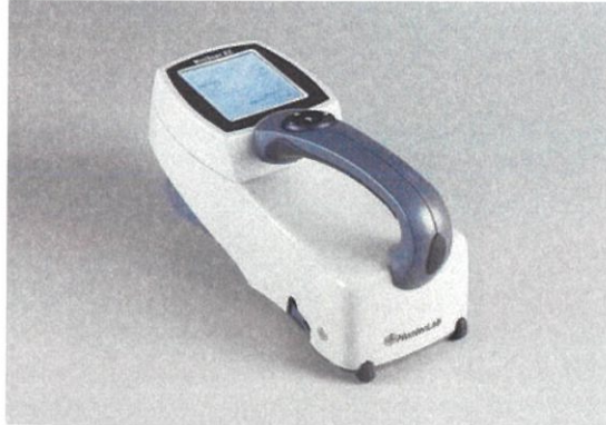
รูปที่ 3.8 เครื่องวัดสีที่ชื่อ HunterLAB
