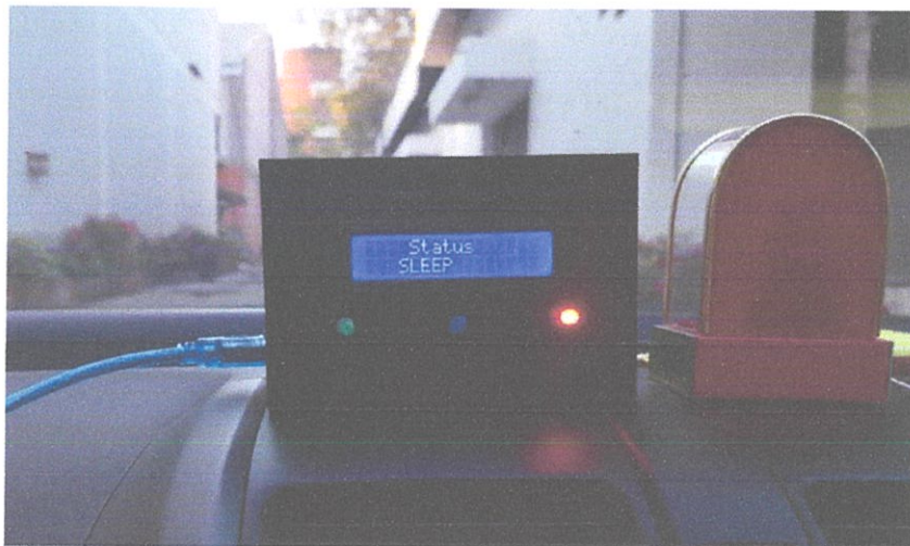
รูปที่ 4.20 ผลการทดสอบขณะที่ผู้ขับขี่อยู่ในสภาวะที่อาจเกิดการหลับใน
