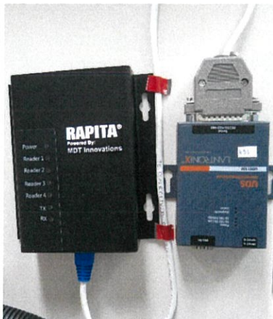
ภาพที่ 3.4 การติดตั้ง Tx และ Lantronix ที่เครื่องจักร
