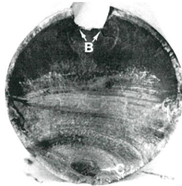
รูปที่ 2.21 ความเสียหายของเพลาคับที่ทำจากเหล็กกล้า AISI 4320 จะเห็นได้ว่าความเสียหายเริ่มเกิดขึ้นที่ปลายร่องลิ่มที่จุด B และขยายวงกว้างออกไปจนสุดท้ายเกิดการแตกแยกที่จุด C (ภาณุฤทธิ์,2009)
