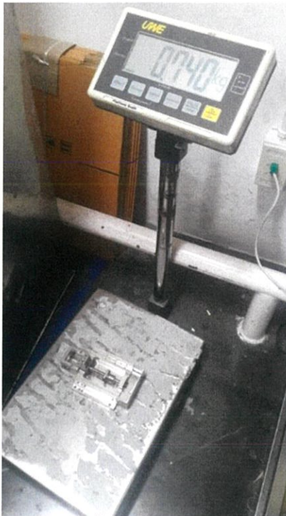
ภาพที่ 9 การชั่งชิ้นส่วน Base กับ Ball screw
