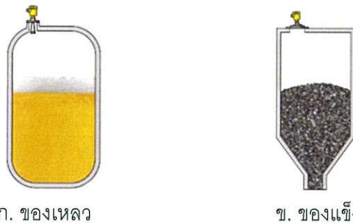
รูปที่ 2.51 ตัวอย่างการใช้งานเครื่องมือวัดระดับแบบเรดาร์
