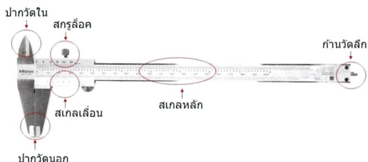
รูปที่ 2.59 ส่วนประกอบของเวอร์เนียคาลิปเปอร์ [11]
