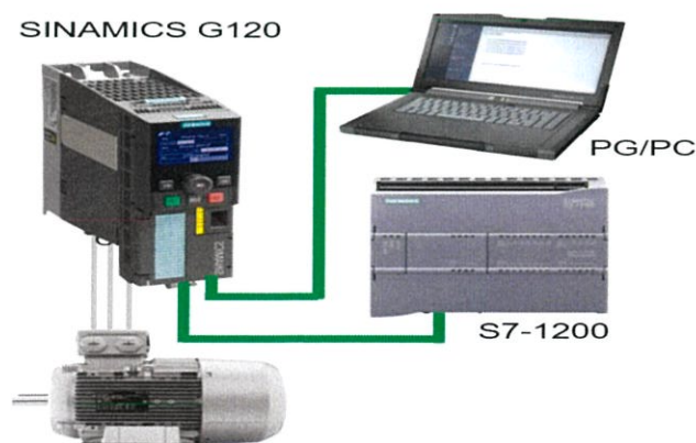
รูปที่ 3.3 รูปแบบการเชื่อมต่อของอุปกรณ์ในการใช้งานฟังก์ชันควบคุมความเร็ว
