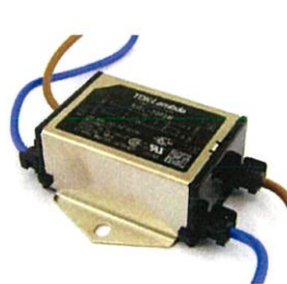
รูปที่ 3.10 วงจรกรองสัญญาณรบกวนที่นำมาทำการออกแบบ
