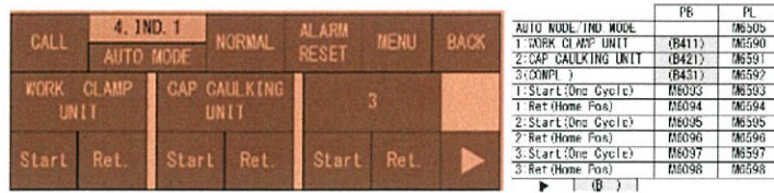
รูปที่ 4.5 หน้าต่างอินดิวิดูอัลและแอตเดรสสำหรับเขียนโปรแกรม
