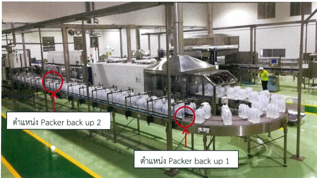
รูปที่ 3.25 สายพานระหว่างเครื่องจัดเรียงแพคกับเครื่องแพคขวด
