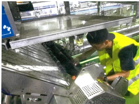
รูปที่ 3.22 ปัญหาฟิล์มใสติดขัดในเครื่องแพคขวด
