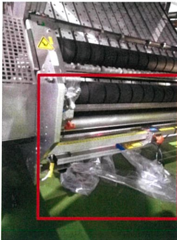
รูปที่ 3.22 ปัญหาฟิล์มใสติดขัดในเครื่องแพคขวด
