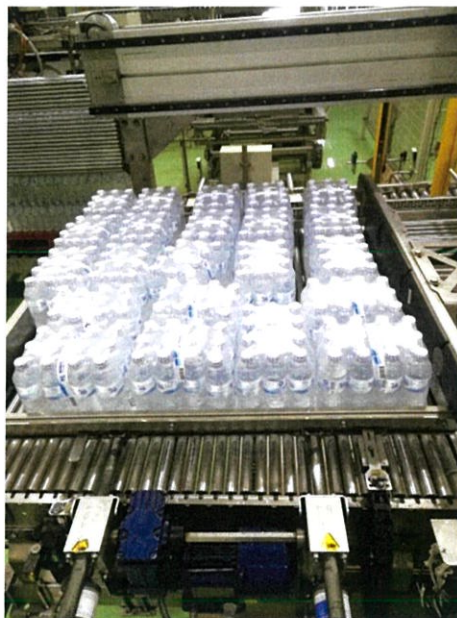
(ข) การจัดเรียงแพคบนเครื่องจัดเรียงแพค (Palletizer machine)
