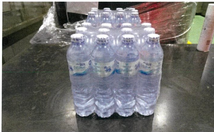
(ข) ขวดน้ำที่ผ่านกระบวนการแพค รูปที่ 3.9 กระบวนการแพคผลิตภัณฑ์
