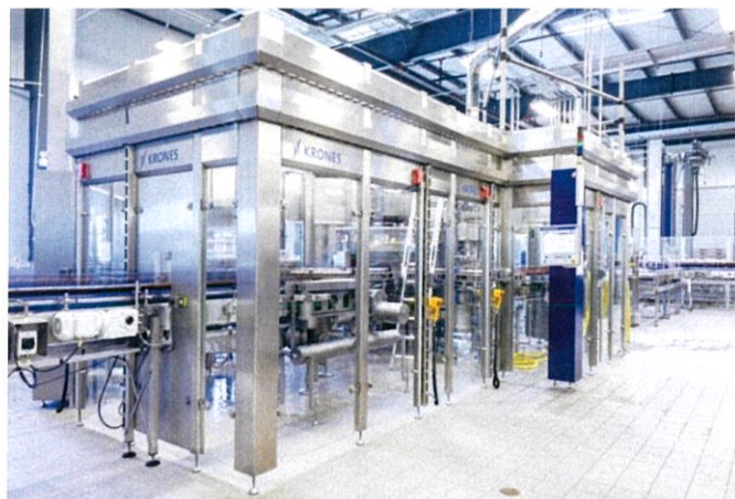
(ก) เครื่องเติมบรรจุภัณฑ์ (Filler machine)
