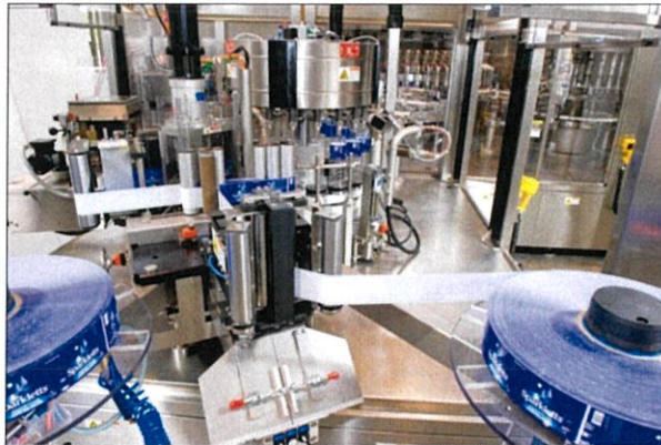
(ก) เครื่องติดฉลาก (Labeler machine)
