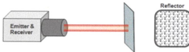
ภาพที่ 2.26 โฟโต้เซ็นเซอร์แบบใช้งานคู่กับแผ่นสะท้อน ที่มา : http://www.pneumax.co.th/Article/ATM-Sensor.php
