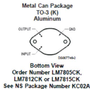
ภาพที่ 19 Datasheet ของ LM78XX
